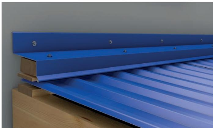
Die Befestigung der Anschlussleiste wird sowohl bei einem längslaufenden Anschluss wie auch bei einem querlaufenden Anschluss auf dem Wellenberg vorgenommen. Lassen Sie stets den langen Schenkel auf das Dach decken. Auch hier wird die Blech-auf-Blechbefestigung mittels einer A2 Edelstahlschraube vorgenommen. Die Befestigung der Anschlussleiste an der Wand richtet sich nach dem Wandbaustoff.
