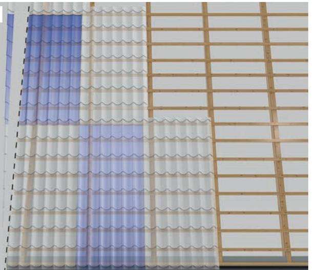
Der überstehende Teil der Platten wird danach abgeschnitten.
