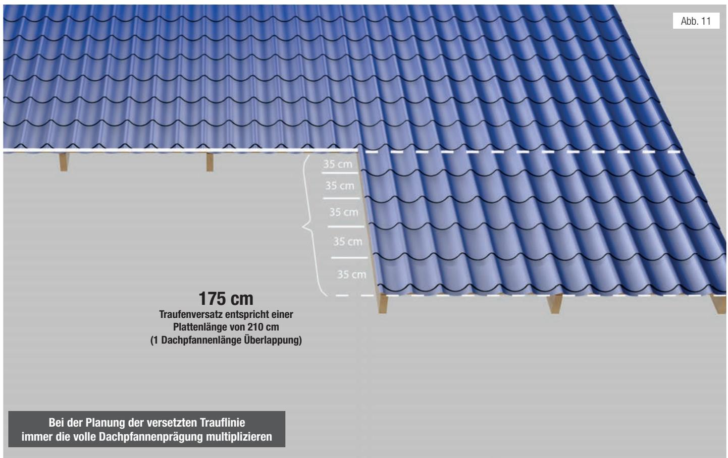
Dieses Maß zur Hauptplattenlänge addiert, ergibt die Gesamtplattenlänge, vorausgesetzt die Montage erfolgt in einer Plattenlänge. Andernfalls Überlappungsvorschrift (Abb. 9) genau beachten!
