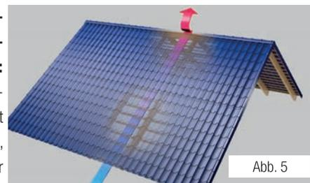
**Achten Sie darauf, dass die Luft an der gesamten Dachfläche im Traufbereich ungehindert eintreten und am First ungehindert austreten kann. Eine Luftzirkulation erfolgt nur, wenn Be- u. Entlüftung funktionsfähig sind. Bei Dächern über 8 m Sparrenlänge oder sehr flachen Dächern ist die Belüftung gesondert zu prüfen.**
